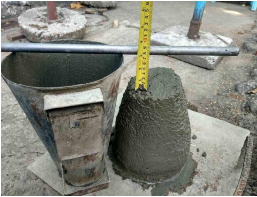
รูปที่ 15 การทดลองยุบตัวของคอนกรีต (SLUMP TEST) และการทดสอบคอนกรีตรูปทรงมาตรฐาน (รูปทรงกระบอก)
